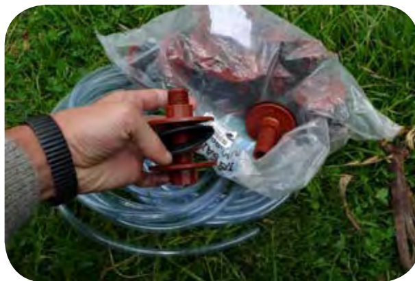
Figura 12: Pasamuros o flange.
